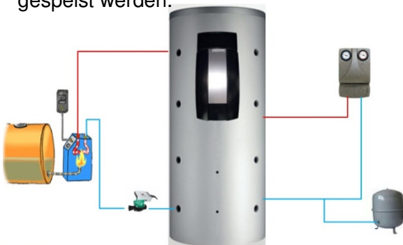
Abbildung 7 Schema einer Bestandsheizungsanlage mit Bestandspufferspeicher und Frischwasserstation
